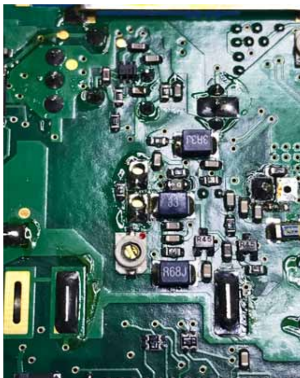
Spule 33 mit dem eingelöteten 18 pF Kondensator
